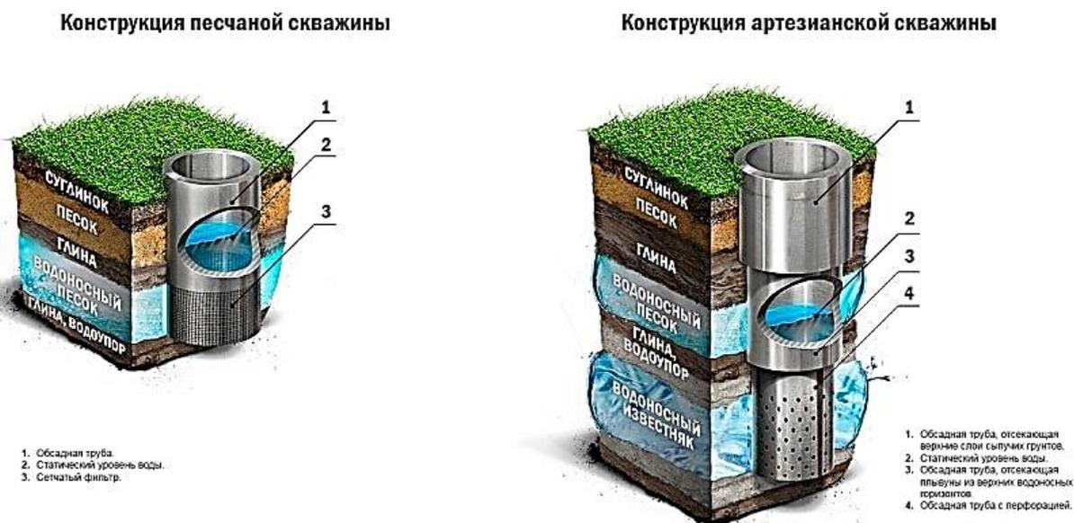
**Рис.3.1.4** Схемы оборудования скважин в различных условиях
