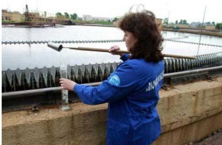
**Рис.6.1.1 Отбор проб из резервуаров антропогенного типа**
