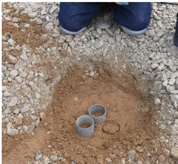
**Рис.6.2.1 Отбор пробы грунта методом режущего кольца**
