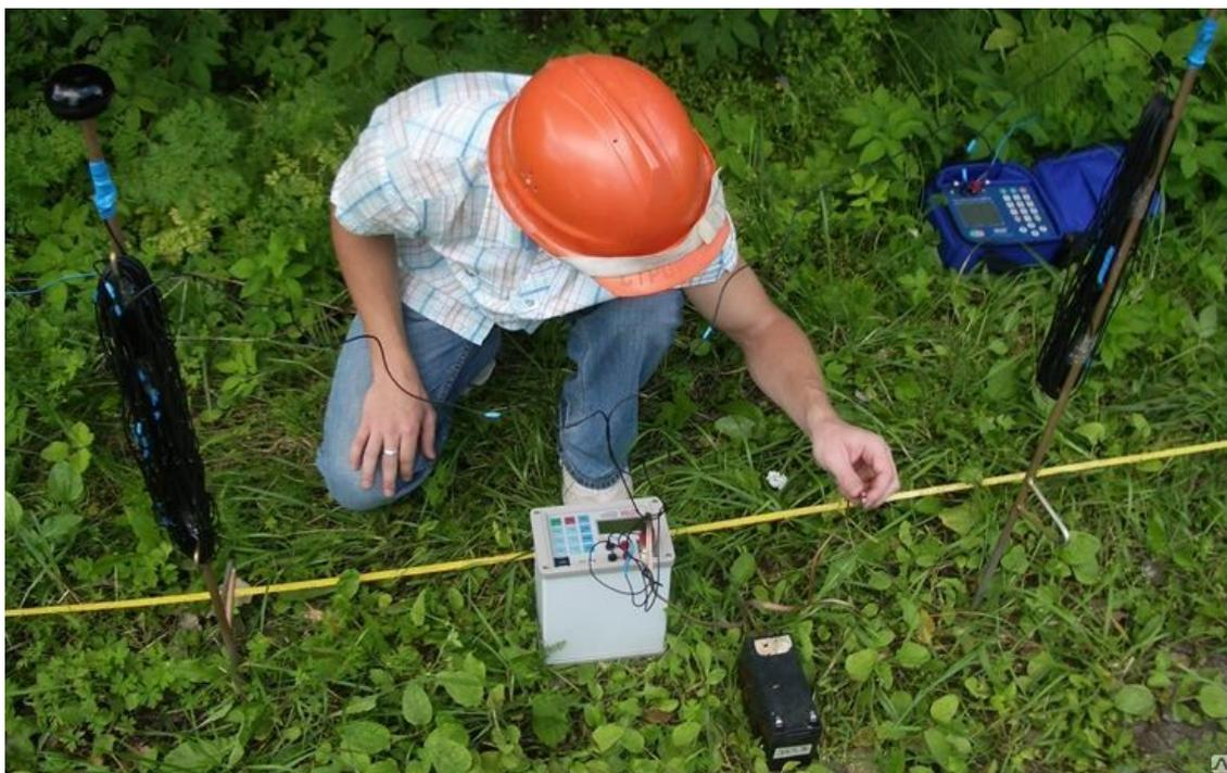
**Рис.7.1.4 Электрическое зондирование ВЭЗ**
