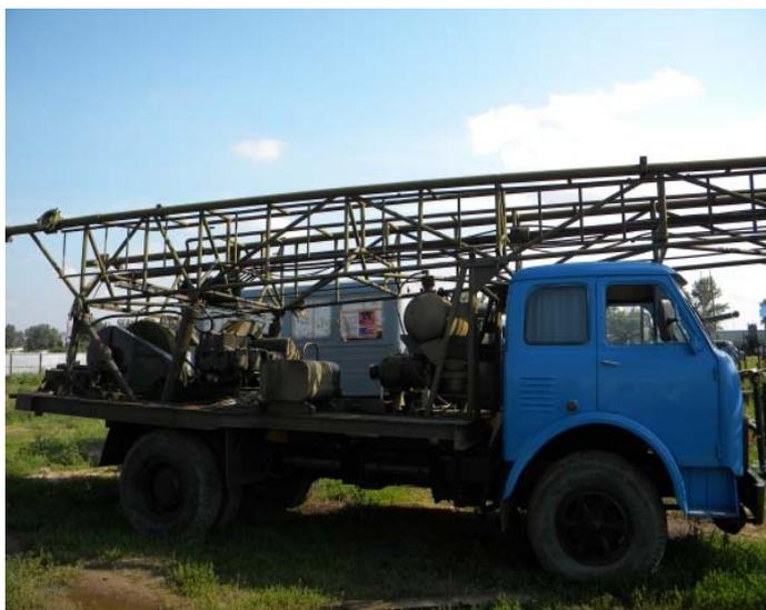
**Рис. 9.2.1 Буровая установка роторного бурения БА-15Н.**
